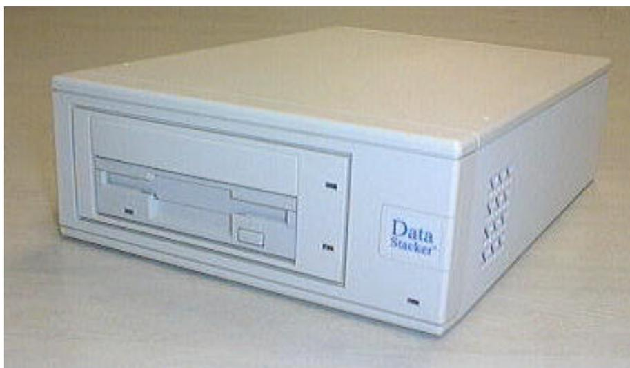
model 9233 は HP9000 シリーズ及びその互換マシンに対応した3モード対応3.5インチ外付SCSIフロッピーディスクドライブです。NECのPC98シリーズコンピュータのフォーマット、1.2MBフロッピーも読み書きできます。
